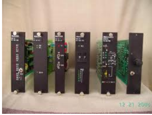
الكاراتات الاليكترونية المسنولة عن التشغيل فى نول القذائف سولزر
